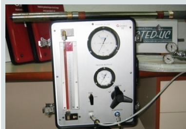
Dilatometría (izq) en muros de fábrica para la obtención de su módulo de elasticidad.
