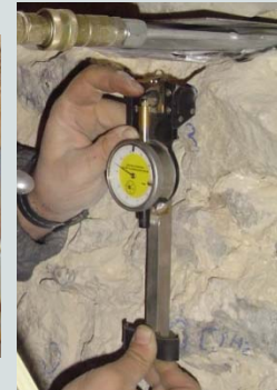
Ensayo de "Gatos Planos" en un muro de mampostería del antiguo Seminario de Comillas: Pueden conocerse niveles tensionales (Gato Simple) y propiedades de deformación (Gatos Dobles).
