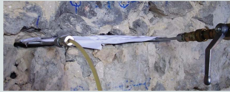
Ensayo de "Gatos Planos" en un muro de mampostería del antiguo Seminario de Comillas: Pueden conocerse niveles tensionales (Gato Simple) y propiedades de deformación (Gatos Dobles).
