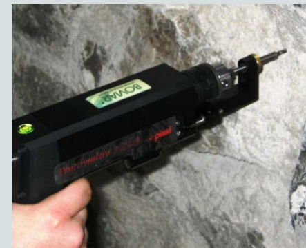
Técnicas Esclerométricas y penetrométricas (abajo): Para el análisis de morteros en fábricas.
